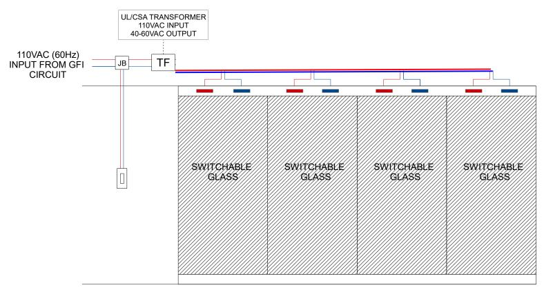
ALL PANELS CONTROLLED SIMULTANEOUSLY
